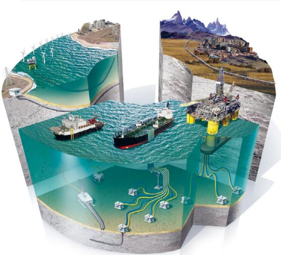
Ces techniques de mesure fournissent une information sur les conditions de fonctionnement et permettent une surveillance en mesurant des variations de température (DTS), de contraintes (DSS), de vibrations (DAS) le long de la fibre.
